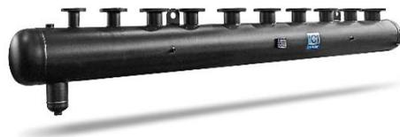
Распределительные коллекторы используются для распределения различных жидкостей (вода, диатермическое масло, пар) в различных областях применения. Коллектор состоит из трубы марки ASTM A 106 Gr.B соответствующего диаметра с приваренными выпуклыми днищами и имеет фланцевые соединения. Количество и диаметр согласовываются с заказчиком. Распределительные коллекторы оснащены нижним патрубком для сбора и слива конденсата.
