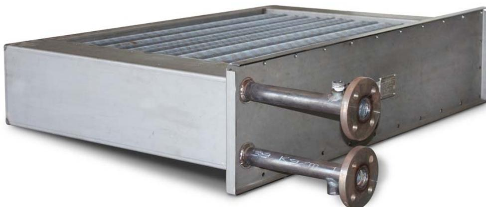
Экономайзер серии **ECO-G** подсоединяется к дымовой камере паровых котлов серии **GSX**. Выбор его установки позволяет достичь сохранения энергии с помощью частичной рекуперации тепла уходящих газов котла путем предварительного нагрева питательной воды. Экономайзер выполнен с возможностью полного извлечения из задней части для облегчения операций по экстренному техническому обслуживанию котла.
