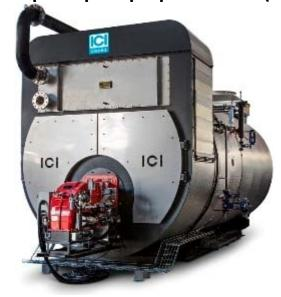
Парогенератор ICI серии GX S с тремя оборотами дымовых газов, проходящим пламенем и омываемым днищем оснащен **ПАРОПЕРЕГРЕВАТЕЛЕМ**, моноблочного типа, с автоматическим функционированием, со всей арматурой, необходимой для ввода в эксплуатацию.
