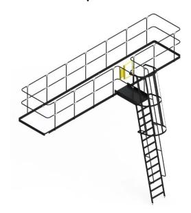
Конструкция выполнена из профилей из углеродистой стали, соединенных между собой специальными швами, гарантирующими парное соединение.
