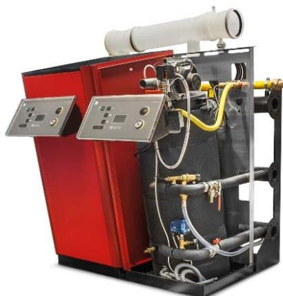
Группа термической конденсации модели **ТВХЛ**, изготовленная из нержавеющей стали с погружной топкой с проходным пламенем, с вертикальными поверхностями теплообмена, предназначена для производства горячей воды с максимальной температурой 110 °С. Оснащена модулирующей горелкой с предварительным смешиванием для газообразного топлива с цилиндрическим корпусом с низким выбросом NOx. Каждый модуль укомплектован платой для модулирующего управления горелками и прямым или смешанным контуром.
