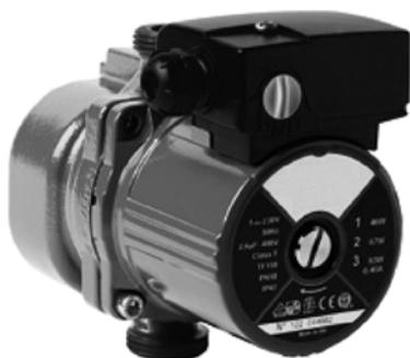
Циркуляционный насос для отопления с мокрым ротором, не нуждается в обслуживании. Двигатель с 3-мя скоростями, переключаемыми вручную, в исполнении IP 42, не нуждается в тепловой защите.
